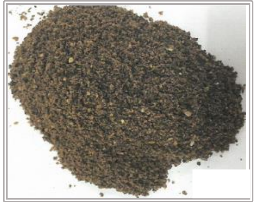
【過熱水蒸気ガス乾燥】 温度：250℃ 時間：30分
