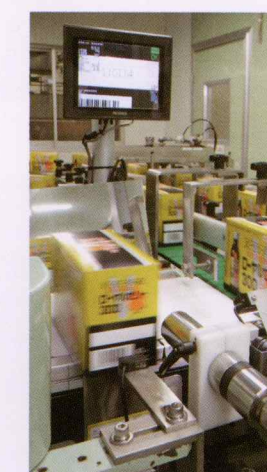
カートナー捺印カメラ検査
